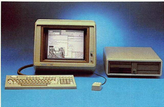
図 1 4404 の外観 14 型のモノクローム・ディスプレイ, 40 M バイトの固定ディスク装置, フロッピー・ディスク装置, キーボード, マウスなどで構成する。主記憶容量は標準 1 M バイト。プロセッサは 68010 を使う。
